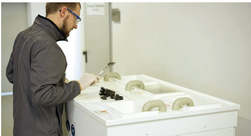
1 Mobile Ätzeinrichtung für das Nital-Ätzverfahren © imq
